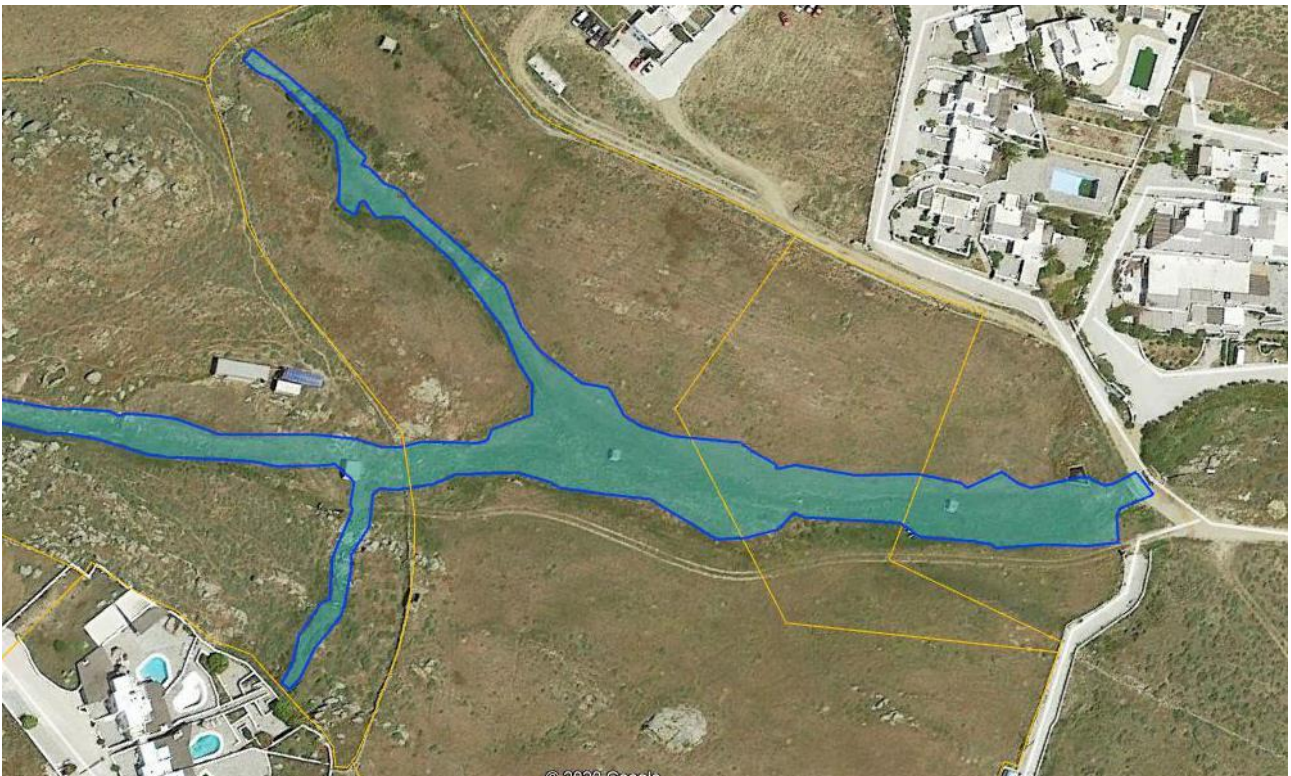
Εικόνα 7: Γραμμή Πλημμύρας σε υπόβαθρο δορυφορικής εικόνας Google Earth του μέσου και κατόντη κύριου κλάδου καθώς και του δυτικού και ανατολικού
