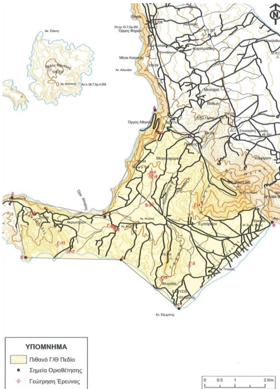
Σχ. 8-5 Όρια πιθανού γεωθερμικού πεδίου χαμηλής ενθαλπίας της Σαντορίνης.
