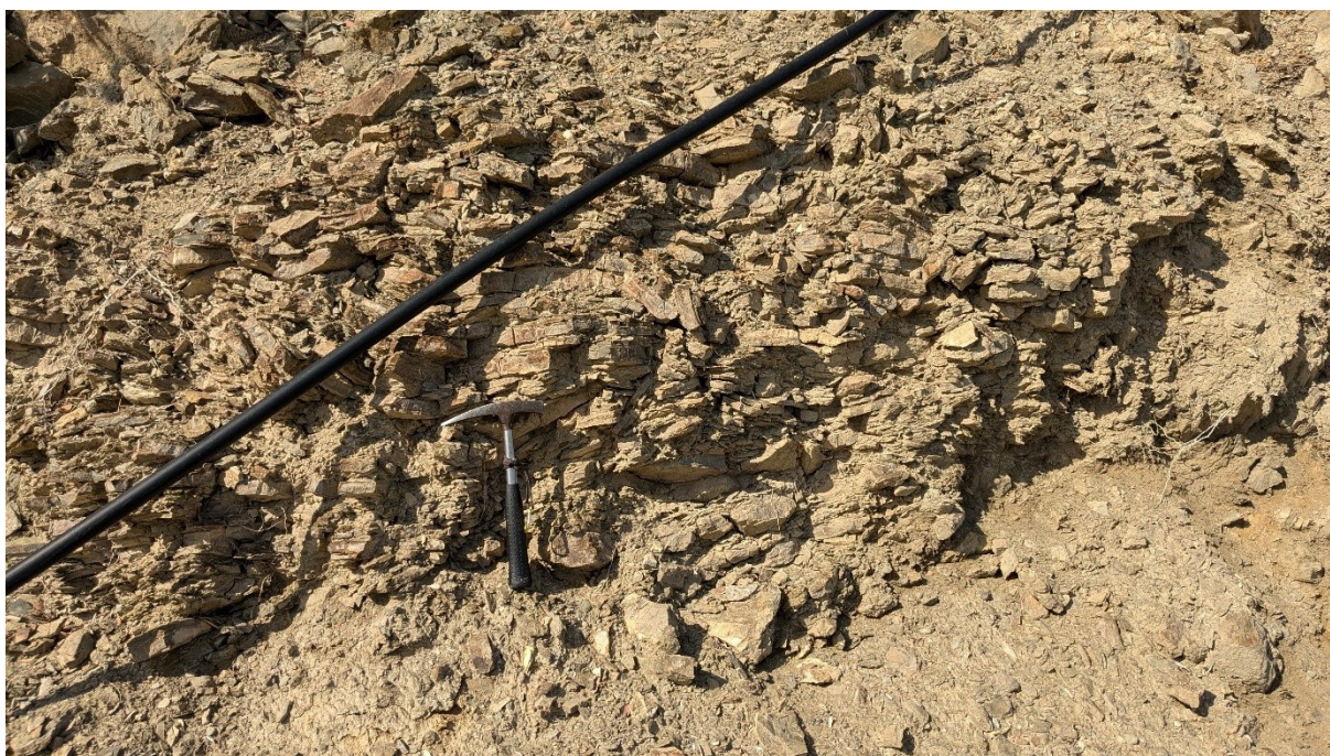
Εικόνα 3-12. Ψαμμιτικός φλύσχος επί του επαρχιακού δρόμου. Διακρίνονται, λόγω τεκτονισμού οι κατακερματισμένες στρώσεις του λεπτοστρωματώδη ιλυόλιθου (Χ: 624295, Υ: 3873215).
