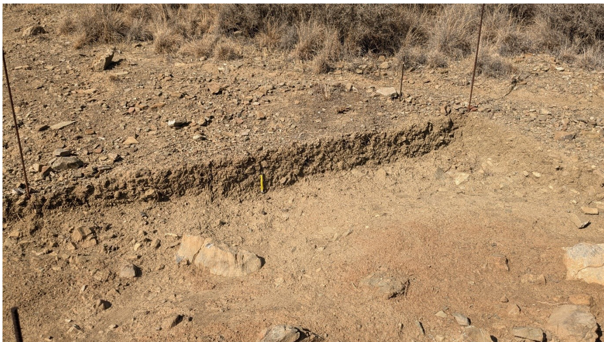
Εικόνα 3-20. Άποψη των αλλουβιακών αποθέσεων στο δυτικό τμήμα επί σκάμματος για την αρχαιολογική έρευνα. Διακρίνεται ο εδαφικός μανδύας από χάλικες και λατύπες εντός μια κύριας μάζας από άμμο και ιλύ (Χ: 624407, Υ: 3873150)
