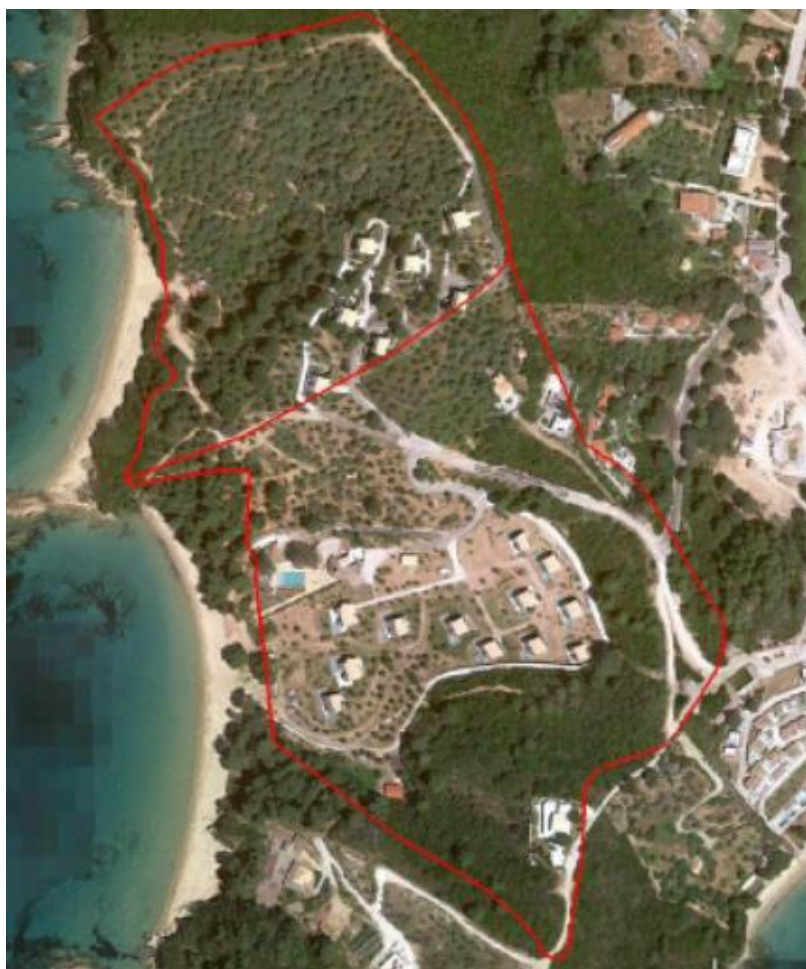
Σχήμα 6.1-19: Όρια υδρολογικών λεκανών περιοχής μελέτης βόρειου και νότιο τμήματος (Πηγή: Μελέτη Γεωλογικής Καταλληλότητας ΕΣΧΑΣΕ - Π1416/271021, ΓΕΩΤ.ΕΡ. Γ. Διδασκάλου & ΣΙΑ Ε.Ε., Οκτ. 2021)
