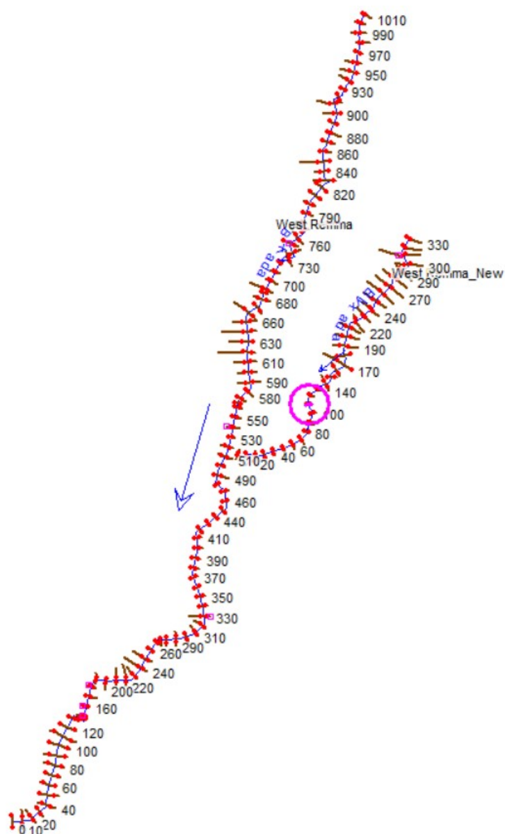
Εικόνα 5-1: Σχηματική παράσταση του υδραυλικού μοντέλου στο HEC-RAS για τον δυτικό κλάδο.
