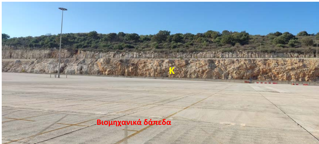
Φ17. Άποψη της στρώσης των ασβεστολίθων (K), υπό τα στοιχεία 23^{\circ}/286^{\circ} , στο δυτικό τμήμα του γηπέδου.
