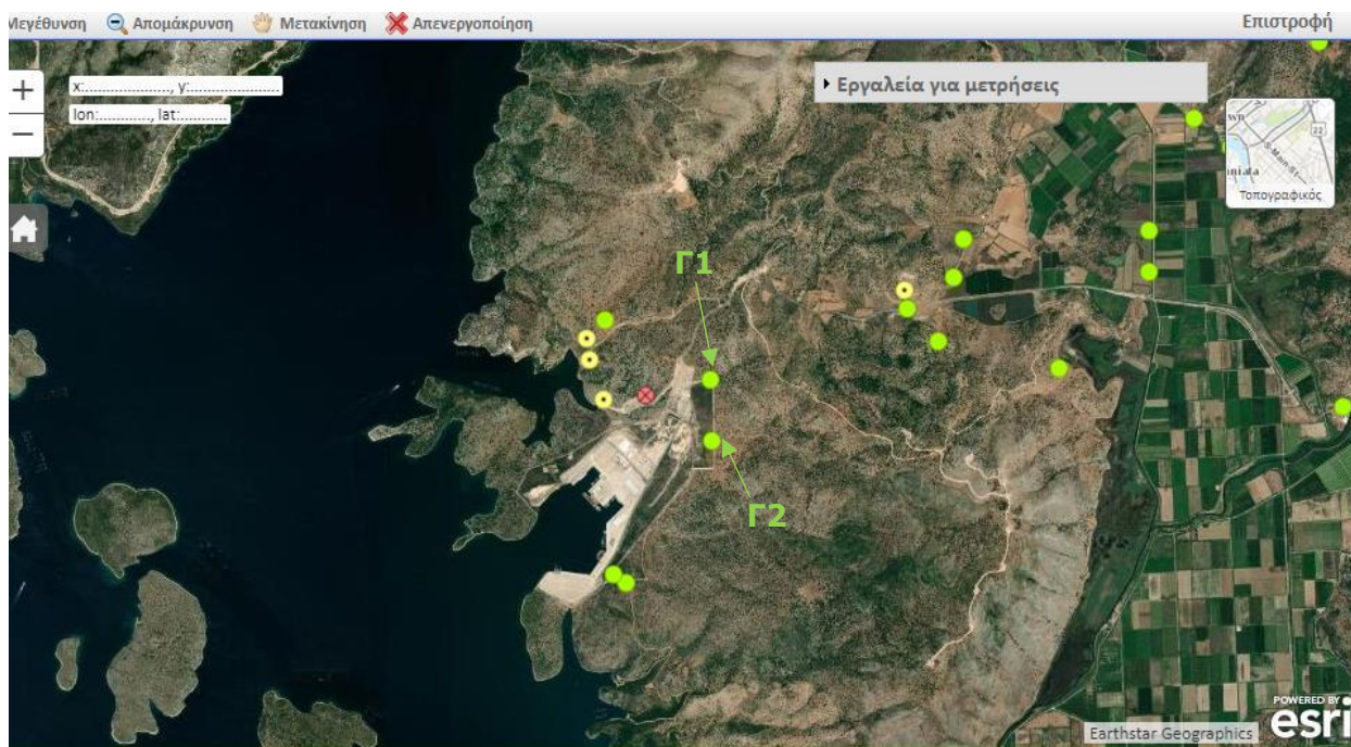
Εικ.4.2. Καταγραμμένα σημεία ύδατος περιμετρικά της εξεταζόμενης έκτασης. Με κόκκινο χρώμα επισημαίνονται τα ανενεργά πηγάδια. Με πράσινο χρώμα οι ενεργές γεωτρήσεις και με κίτρινο χρώμα τα ενεργά πηγάδια (πηγή : Βάση δεδομένων ΥΠΕΝ – ΕΜΣΥ, Δεκ.2022).
