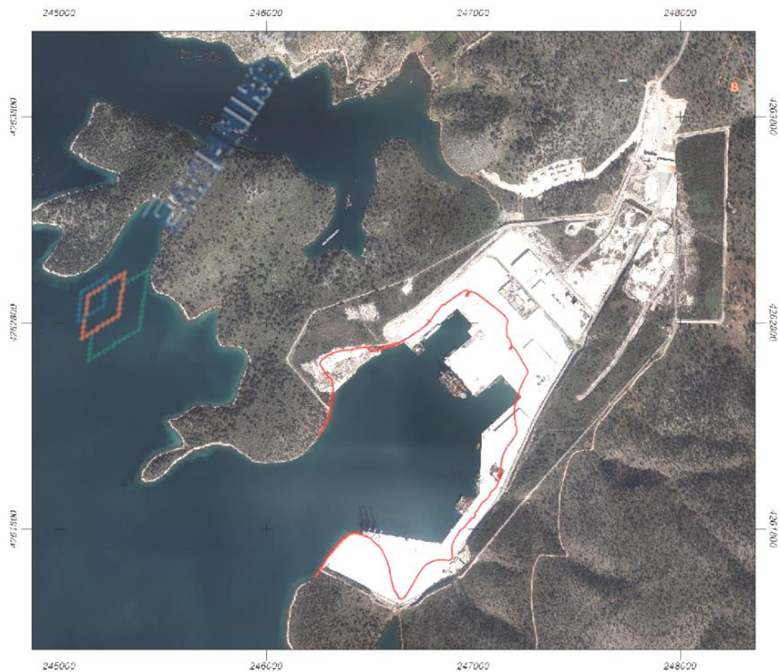
Εικ.2.3. Αλλοίωση της φυσικής ακτογραμμής (κόκκινη γραμμή) λόγω κατασκευής της ΝΑ.ΒΙ.ΠΕ. Αστακού (Πηγή: ΚΤΗΜΑΤΟΛΟΓΙΟ ΑΕ, συντεταγμένες : ΕΓΣΑ 87).
