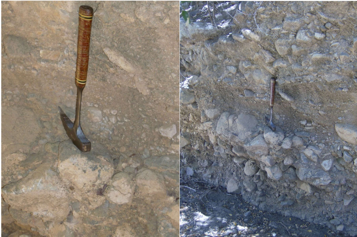
Φωτ.3. Λεπτομέρεια (αριστερά) και γενική άποψη των συνεκτικών ποταμοχειμάρριων αποθέσεων (δεξιά). Διακρίνεται ο πολύμικτος χαρακτήρας τους και η ισχυρή συγκόλλησή τους με ασβεστιτικό υλικό.
